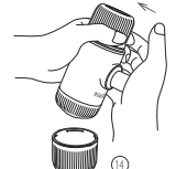
14 Sostenga el Nanopresso con dos manos, como se mostró arriba. Comience a bombear por encima de una taza. Las 8 primeras presiones llenarán el filtro canastilla de agua. Continúe bombeando hasta que deje de salir café.
