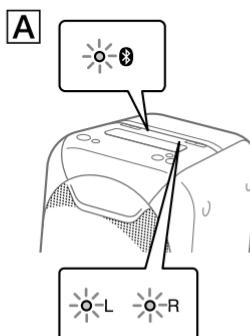
4 Appuyez plusieurs fois sur FUNCTION – PAIRING sur le système B jusqu'à ce que l'indicateur
