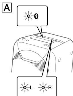
**4 Druk herhaaldelijk op FUNCTION – PAIRING op het systeem B tot het ☰ (BLUETOOTH)-lampje op het apparaat brandt.**
