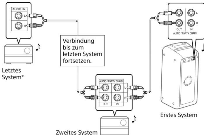
\* Schließen Sie das System, das nicht mit der verdrahteten Party Chain-Funktion ausgestattet ist, als das letzte System an. Wählen Sie unbedingt die Audio-Eingangsfunktion an dem letzten System. Bei dieser Konfiguration kann der Ton des letzten Systems gegenüber den anderen Systemen verzögert sein.
