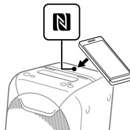
Complete la conexión siguiendo las instrucciones visualizadas en el dispositivo BLUETOOTH. Cuando se establece la conexión BLUETOOTH, el indicador
