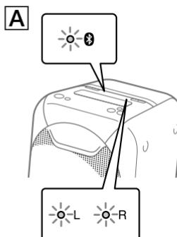
**4** Drücken Sie FUNCTION – PAIRING am System **B** wiederholt, bis die Anzeige  $\otimes$  (BLUETOOTH) am Gerät aufleuchtet.
