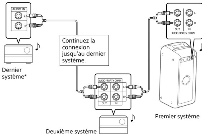
\* Connectez le système qui n'est pas doté de la fonction Chaîne pour soirée câblée au dernier système. Pensez à sélectionner la fonction Entrée audio sur le dernier système. Dans cette configuration, le son émis par le dernier système risque d'être en retard par rapport aux autres.
