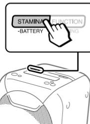
**3 El mensaje de guía de voz se escucha y el indicador CHARGE parpadea de la forma siguiente de acuerdo con el nivel de batería restante.**
