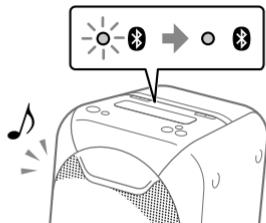
Je nach dem BLUETOOTH-Gerät kann die Verbindung nach Abschluss des Pairing-Vorgangs automatisch beginnen.
