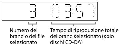
Per i file MP3/WMA, nel display **[10]** appare prima il nome o il titolo del file selezionato, mentre il tempo di riproduzione totale non viene visualizzato.
