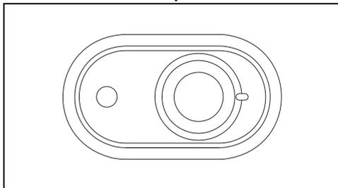
Tourner la manette du thermostat de la position ● (minimum) à **5** (maximum) en fonction de la température voulue.
