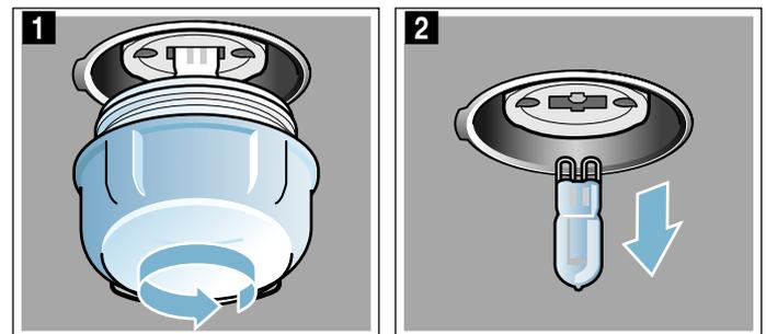
4. Revissez le cache en verre. Selon le type d'appareil, le cache en verre est équipé d'un anneau d'étanchéité. Remettez l'anneau d'étanchéité en place avant de visser.
