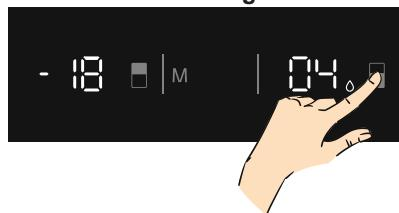
Druk op de instelknop van de koelkast totdat het symbool voor de snelkoelstand op het scherm verschijnt. De zoemer zal een piepgeluid gegeven. De stand wordt ingesteld.
