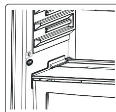
Um sicher zu gehen, dass Sie in diesem Bereich die geringste Temperatur haben, sorgen Sie dafür, dass das Regal, wie in der Abbildung gezeigt, auf der Höhe dieses Symbols angebracht ist. Die obere Begrenzung des kältesten Bereichs wird durch die Unterseite des Aufklebers (Pfeilspitze) angegeben. Die obere Ablage des kältesten Bereichs
