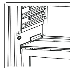
Om er zeker van te zijn dat u een lage temperatuur in dit gedeelte heeft, zorg u ervoor dat het schap is geplaatst op het niveau van dit symbool, zoals
