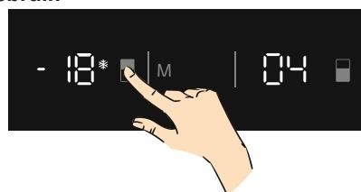
Druk op de instelknop van de vriezer totdat het symbool voor de snelvriesen op het scherm verschijnt. De zoemer zal een piepgeluid gegeven. De stand wordt ingesteld.
