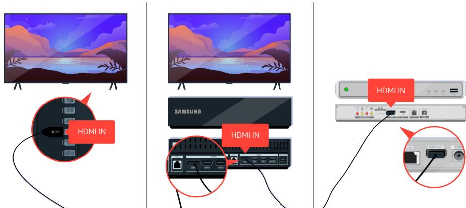
Si le problème persiste, essayez de connecter un autre appareil externe au téléviseur à l'aide d'un câble HDMI. Si l'affichage est correct, il se peut que votre appareil externe soit défectueux.
