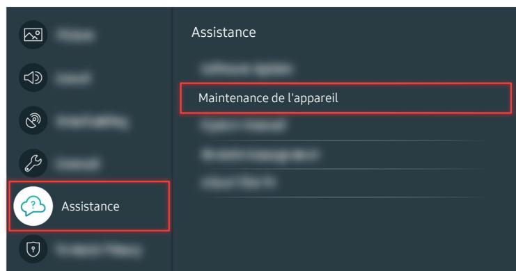
Accédez à > **Paramètres** > **Assistance** > **Maintenance de l'appareil** > **Diagnostic automatique** > **Test du son** pour vérifier le son.
