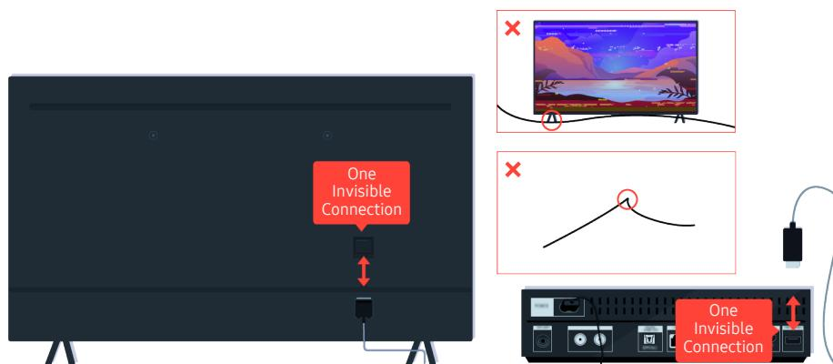
Si le problème persiste alors que votre téléviseur utilise la connexion One Invisible Connection, déconnectez le câble One Invisible Connection entre le téléviseur et le boîtier One Connect (OC), puis reconnectez-le. Veillez à ce que le câble One Invisible Connection ne soit pas pincé ou ne forme pas un arc trop fermé.
