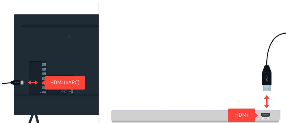
Si la barre de son est muette alors qu'elle est connectée au téléviseur avec un câble HDMI, vérifiez le connecteur HDMI (eARC) à l'arrière du téléviseur.
