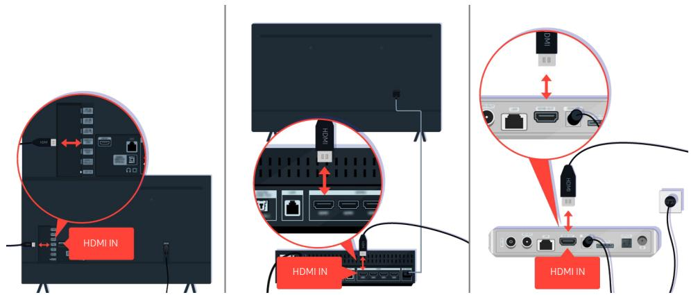
Vérifiez le branchement de l'antenne et du câble HDMI.
