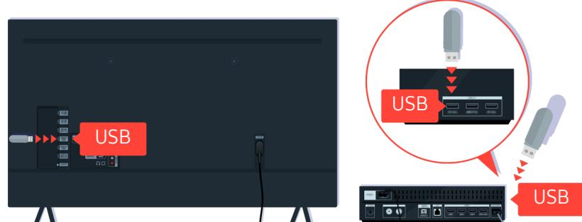
Insérez le périphérique USB dans le port USB situé à l'arrière de votre téléviseur ou sur le côté du boîtier One Connect.
