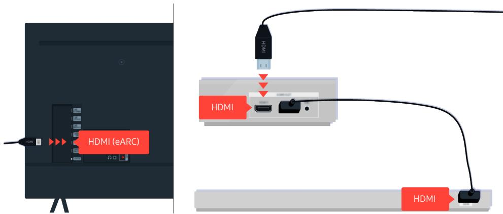
Si votre barre de son est connectée à un récepteur alors que celui-ci est connecté au téléviseur à l'aide d'un câble HDMI, vérifiez le connecteur HDMI à l'arrière du téléviseur. Le câble doit être connecté au port HDMI (eARC) de votre téléviseur.
