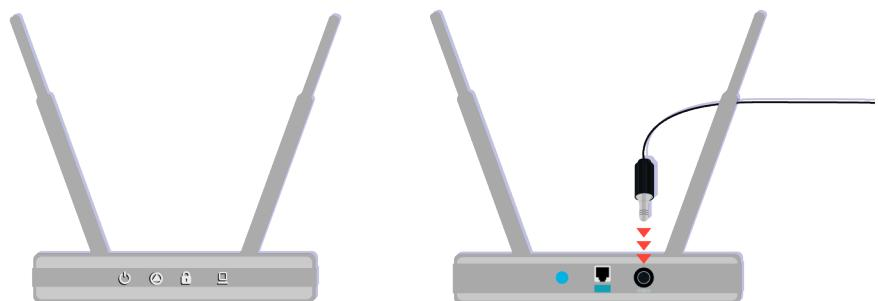
Assurez-vous que votre point d'accès est connecté à Internet. Si ce n'est pas le cas, il peut être nécessaire de débrancher puis de rebrancher le câble d'alimentation.
