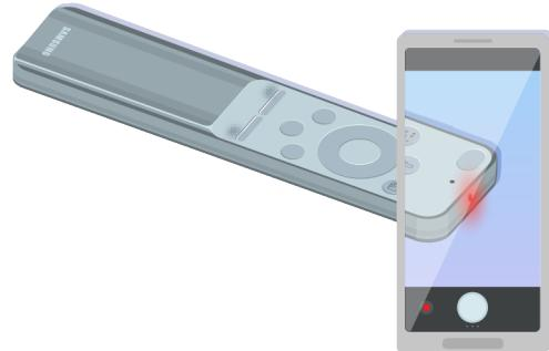
Vous pouvez vérifier si le signal est transmis en appuyant sur le bouton marche/arrêt et en observant l'avant de la télécommande à l'aide de la caméra de votre smartphone.
