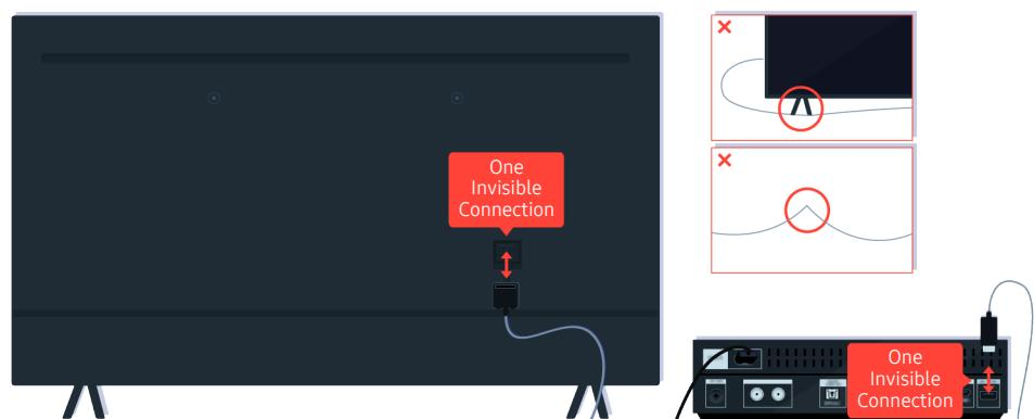
Déconnectez et reconnectez le câble One Invisible Connection entre le téléviseur et le boîtier One Connect (OC). Assurez-vous que le câble One Invisible Connection ne soit pas pincé ou ne forme pas un arc trop fermé.
