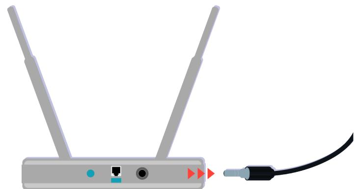
Essayez de redémarrer le point d'accès en débranchant puis rebranchant le connecteur d'alimentation. Cela peut prendre 1 à 2 minutes avant que le point d'accès soit de nouveau opérationnel après un redémarrage.
