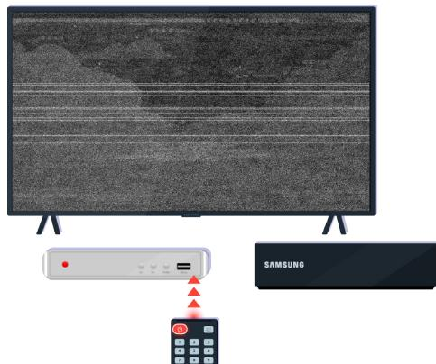
Si vous utilisez une télécommande multimarque (MBR) ou une télécommande universelle et qu'elle est inopérante avec un appareil externe, rapprochez celui-ci du boîtier One Connect.
