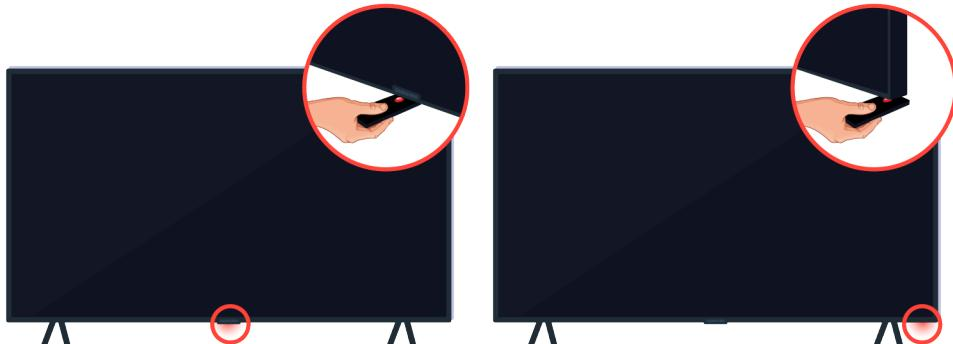
Pour trouver aisément le capteur de la télécommande, placez un réflecteur (un miroir, par exemple) sous le téléviseur.
