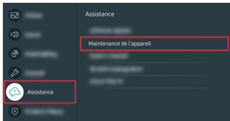
Sélectionnez > **Paramètres** > **Assistance** > **Maintenance de l'appareil** > **Diagnostic automatique** > **Informations de signal** pour vérifier la force du signal.
