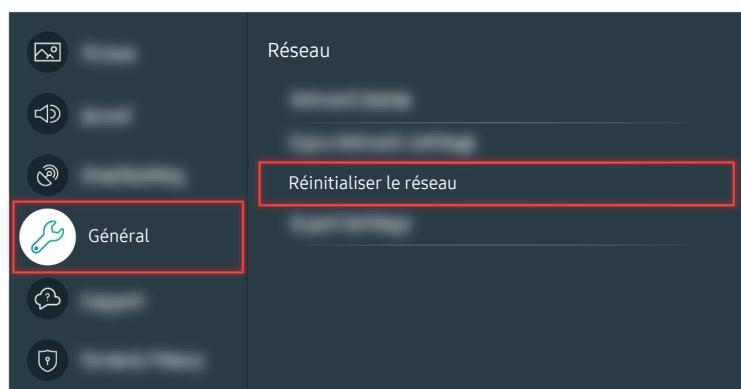
Si le réseau n'est pas connecté, il peut être nécessaire de le réinitialiser.
