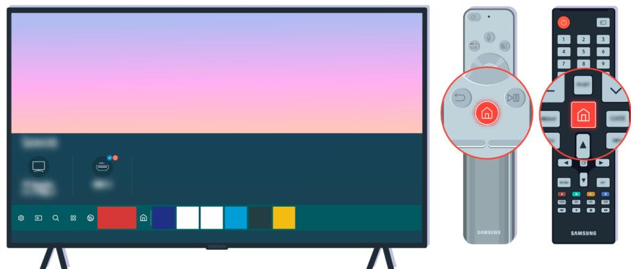
Vérifiez également que la source sélectionnée dans la Barre d'accès rapide (🏠 > ➔ **Source**) est correcte.
