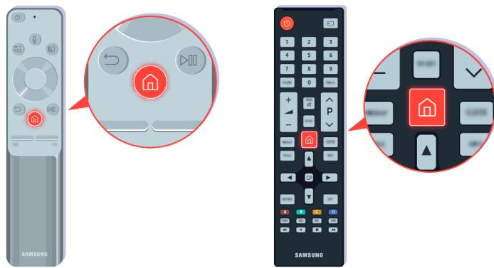
Si le problème disparaît pendant le test, vérifiez le signal du téléviseur. Sur la télécommande, appuyez sur le bouton .
