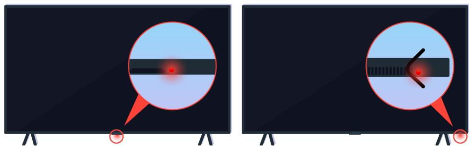
Vérifiez que le signal de la télécommande infrarouge est transmis et reçu.
