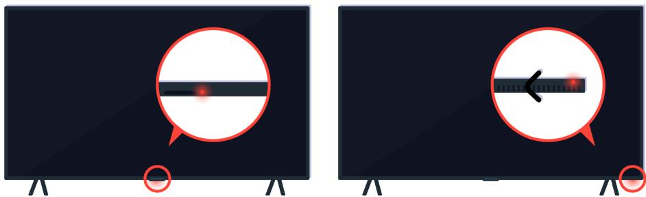
Si votre téléviseur ne s'allume pas, vérifiez si le capteur de la télécommande est allumé.
