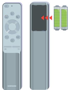
Si vous ne voyez pas de signal infrarouge, remplacez les piles de la télécommande.
