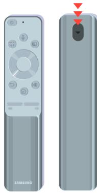
Si vous ne voyez pas de signal infrarouge, remplacez les piles de la télécommande.
