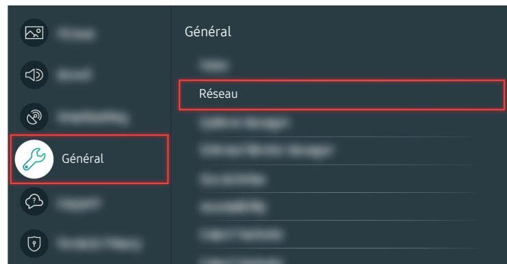
Si le problème persiste, sélectionnez > **Paramètres** > **Général** > **Réseau** > **État du réseau** > **Param. IP** pour choisir un autre serveur DNS. Si un test se produit, annulez-le et sélectionnez **Param. IP**.
