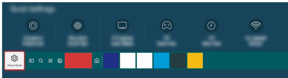
Accédez à > **Paramètres** > **Assistance** > **Maintenance de l'appareil** > **Diagnostic automatique** > **Test du son** pour vérifier le son.
