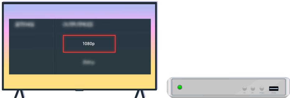
Si le problème persiste, vérifiez les paramètres de sortie vidéo dans le menu Paramètres de l'appareil externe et assurez-vous que votre téléviseur prend en charge le mode de sortie vidéo.
