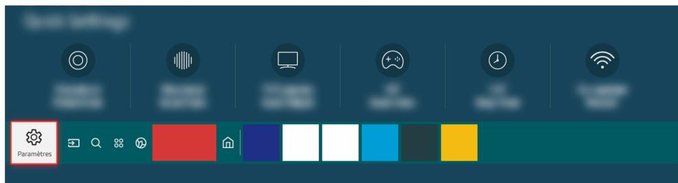
Si le test révèle un problème, sélectionnez > **Paramètres** > **Son** > **Paramètres expert** > **Réinitialiser le son**.
