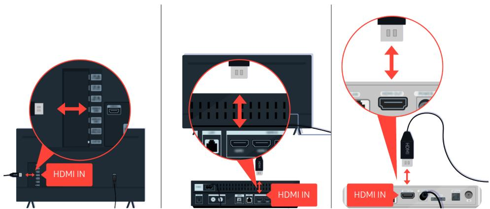
Débranchez et rebranchez d'abord les câbles d'alimentation et les câbles HDMI à l'arrière de votre téléviseur ou du boîtier One Connect (OC), puis débranchez le câble d'alimentation et rebranchez-le sur le secteur.
