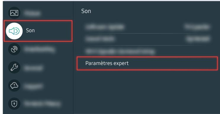
Si le test révèle un problème, sélectionnez > Paramètres > Son > Paramètres expert > Réinitialiser le son.
