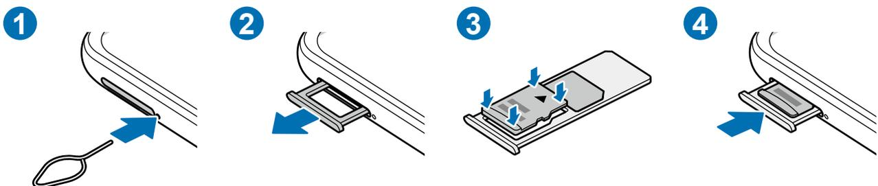
1 Insérez la broche d'éjection dans l'orifice près du plateau pour le déverrouiller.
