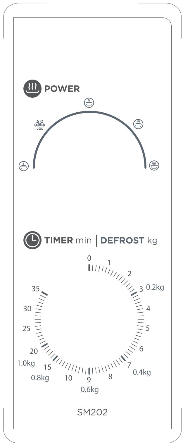
1. Sélectionnez la puissance en tournant le bouton de sélection de la puissance et décongélation dans le sens des aiguilles d'une montre.
