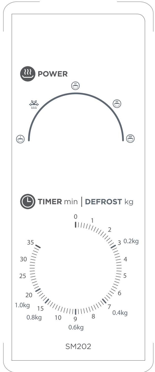
1. Ajuste la potencia girando el mando selector de potencia y descongelación.
