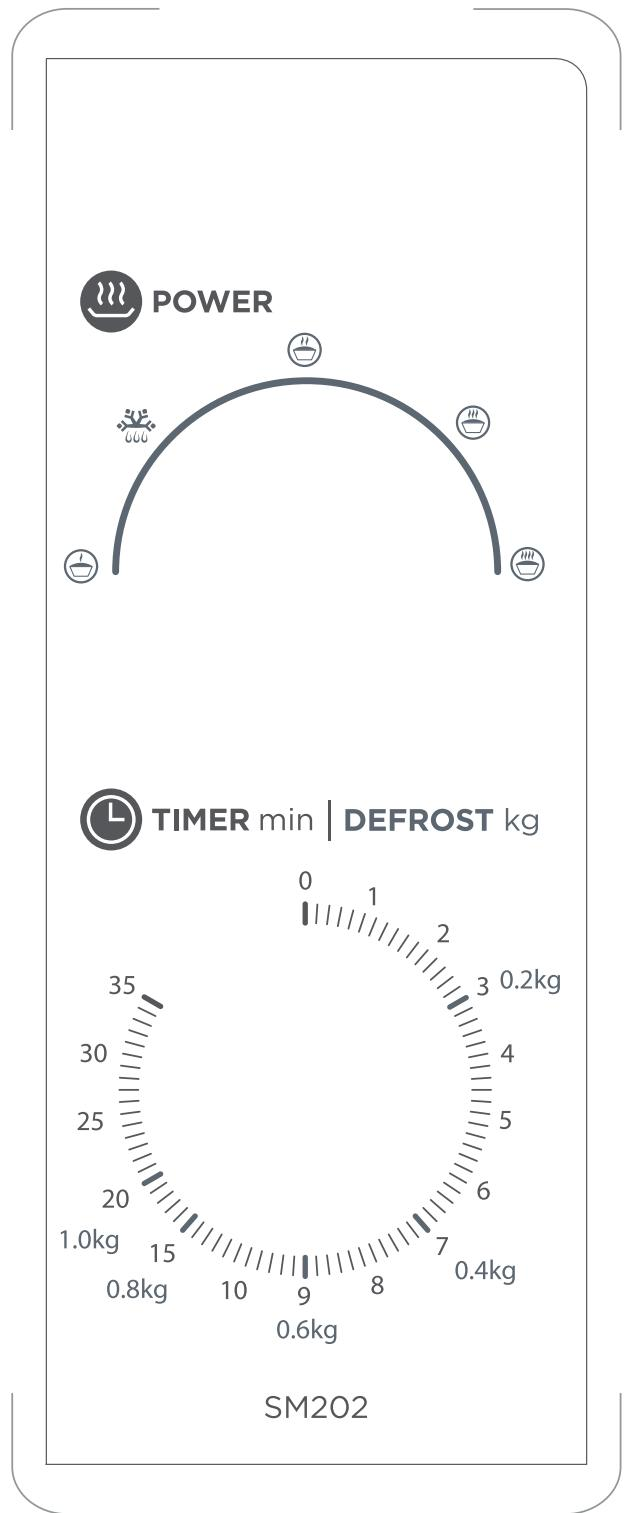
1. Stel het magnetronvermogen in door de aan/uit en ontrooien-keuzeknop naar het gewenst niveau te draaien.
