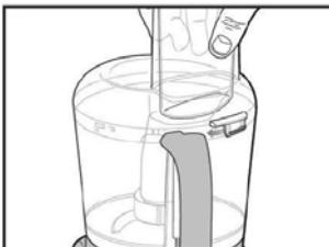
**NOTA:** Su procesador de alimentos presenta un sistema de bloqueo de seguridad. El electrodoméstico no funcionará a menos que el tazón y su tapa estén alineados y bloqueados correctamente en su posición.
