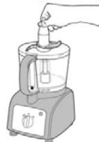
5. Placez le couvercle du bol sur le bol, en veillant à ce que la flèche sur le couvercle du bol s'aligne avec le symbole de déverrouillage situé sur le bord du bol.
