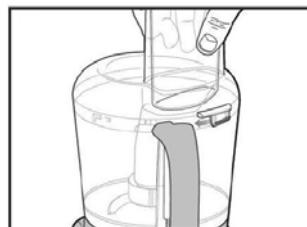
**OPMERKING:** uw keukenmachine is uitgerust met een beveiligingssysteem voor de vergrendeling. Het apparaat zal niet werken als de kan of het deksel van de kan niet vastgeklikt zijn.
