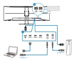
3. Accédez au menu OSD. Accédez à la section KVM et sélectionnez "USB amont1" ou "USB amont2" pour basculer le contrôle des périphériques d'un appareil à l'autre. Répétez simplement cette étape pour commuter le système de contrôle à l'aide d'un seul ensemble de périphériques.
