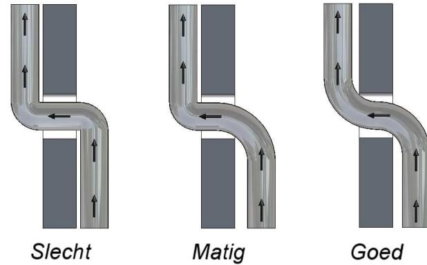
Verminder de uitlaatsectie niet door een te kleine of te weinig doorlatende muurrooster of dergelijke, want hoe minder de afvoer geremd wordt, hoe groter het nuttige effect van uw dampkap.
