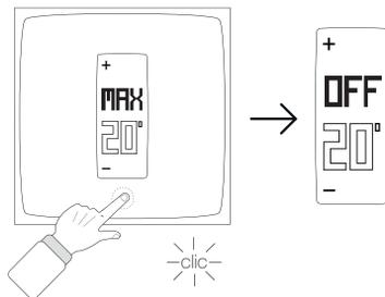
*Note* : Si le Thermostat ne parvient pas à allumer / éteindre votre chaudière, il y a un problème avec le raccordement à l'entrée Thermostat de celle-ci. Dans ce cas, vérifiez vos branchements à l'aide de la photo faite des branchements de votre ancien thermostat.
