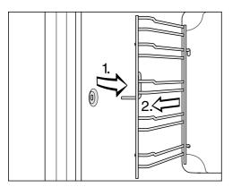
■ Tirez les grilles de support vers l'avant hors de la fixation (1.) et retirez-les (2.).
