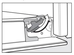
Déverrouillez les étriers de blocage en les tournant jusqu'à la butée. Un démontage incorrect de la porte peut endommager le four vapeur combiné.
