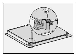
Tournez les deux dispositifs de blocage des vitres vers l'intérieur à l'aide d'un tournevis plat.
