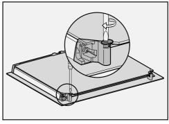
Tournez les deux dispositifs de blocage des vitres vers l'extérieur à l'aide d'un tournevis plat.
