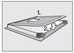
Glissez la vitre intérieure dans la baguette en plastique, côté sérigraphié mat vers le bas, et déposez-la entre les dispositifs de blocage.
