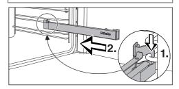
Accrochez le rail coulissant FlexiClips devant sur la tige inférieure d'un niveau (1), puis faites-le glisser le long de la tige dans l'enceinte de cuisson (2).
