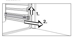
■ Soulevez le rail coulissant FlexiClips par l'avant (1.) et sortez-le en le faisant glisser le long de la barre (2.).
