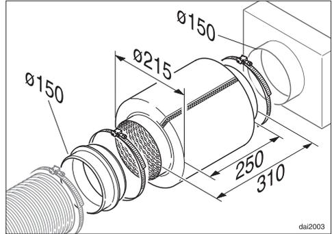
Vous pouvez installer un amortisseur de bruit dans la conduite d'évacuation (accessoires en option). Ce dispositif permet de limiter davantage les nuisances sonores.
