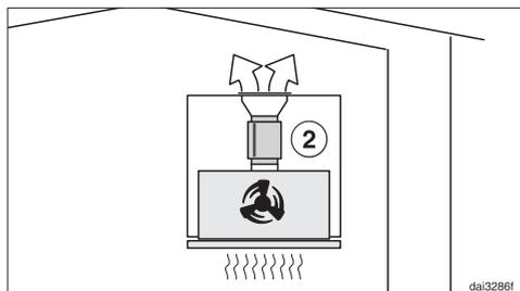
Le réducteur de bruit se trouve entre le raccord d'évacuation et la grille d'aération ②. Assurez-vous que l'espace d'encastrement est suffisant.
