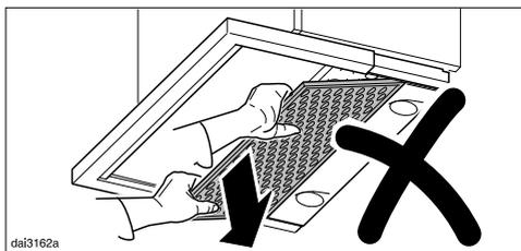
Ne pas rabattre le filtre à graisses vers le bas lorsque vous le retirez ! Ceci pourrait engendrer des dommages au niveau des baguettes de support.
