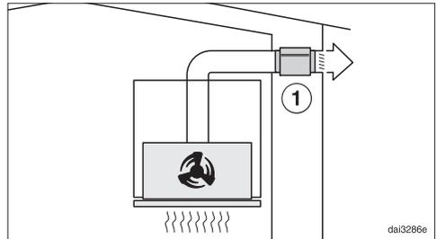
L'amortisseur de bruit limite les bruits de ventilation vers l'extérieur, ainsi que les bruits extérieurs qui arrivent dans la cuisine par le biais de la conduite d'évacuation (le bruit de la rue par exemple). Il convient de placer l'amortisseur de bruits le plus près possible devant la sortie de l'air d'évacuation ①.
