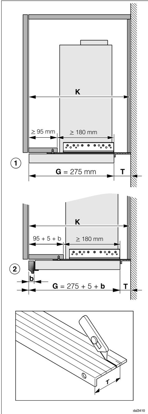
① Exemple : installation sans panneau de façade, le bord avant du déflecteur rentre borde le bord avant du corps de l'armoire. Un soubassement de 95 mm minimum est nécessaire.
