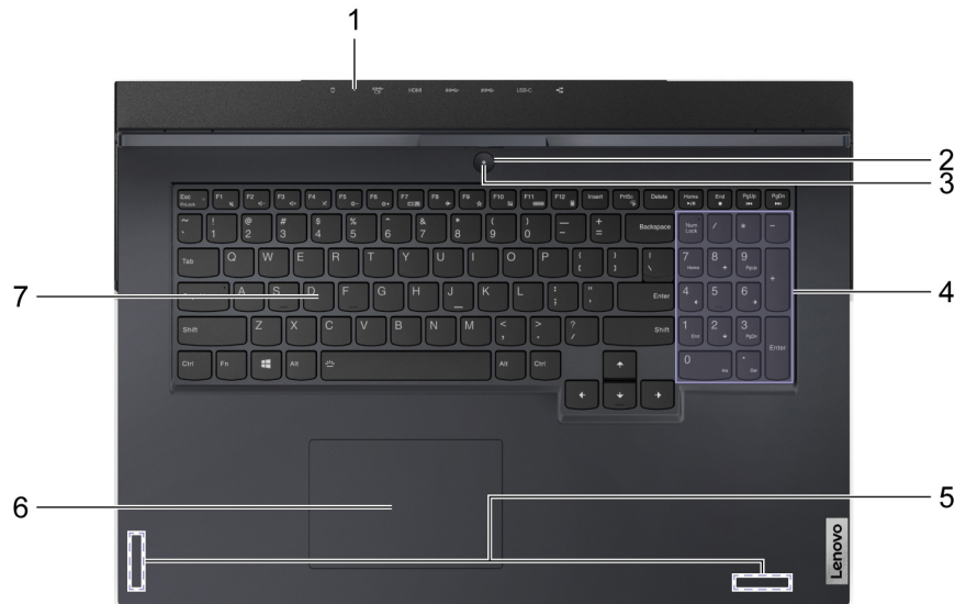
Figuur 4. Bovenaanzicht – 17 inch modellen
