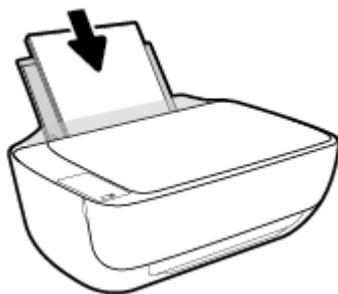
4. Faites glisser le guide de largeur vers la droite jusqu'à ce qu'il entre en contact avec le bord du papier.
