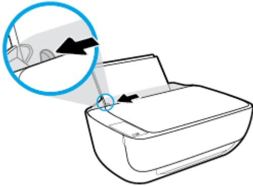
3. Insérez une ou plusieurs enveloppes à l'extrême droite du bac d'entrée et faites glisser la pile jusqu'à ce qu'elle soit calée.
