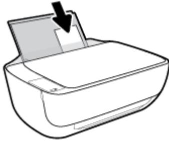
4. Faites glisser le guide de largeur vers la droite jusqu'à ce qu'il entre en contact avec le bord du papier.
