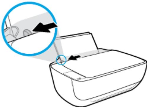
3. Insérez une pile de papier photo à l'extrême droite du bac d'entrée dans le sens de la longueur et face à imprimer vers le haut. Faites-la glisser jusqu'à ce qu'elle soit calée.
