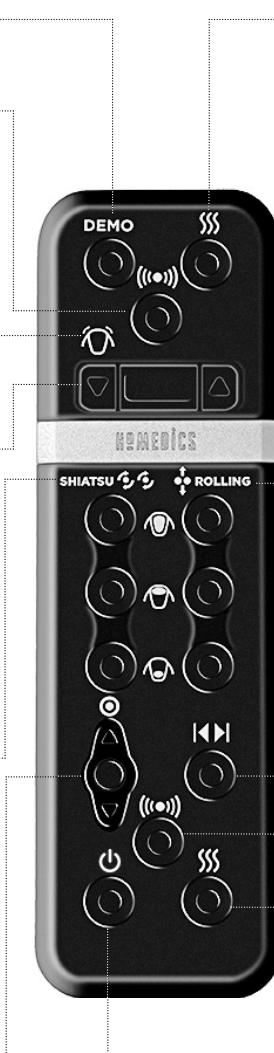
**Bouton alimentation ⚡** - Pour mettre en marche l'appareil, appuyer d'abord sur le bouton ALIMENTATION. Le voyant LED rouge s'allume pour confirmer votre sélection. Pour arrêter, appuyer simplement à nouveau sur le bouton. Le voyant LED blanc clignote pendant que le mécanisme de massage du dos revient à son point le plus bas, puis il s'éteint.
