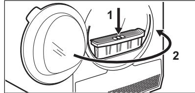
**1)** Verwijder de pluizen indien nodig uit de filterhouder en pakking. U kunt hiervoor een stofzuiger gebruiken.
