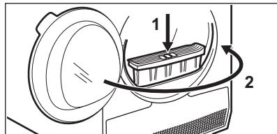
1) Au besoin, retirez les peluches du logement et du joint du filtre. Vous pouvez utiliser un aspirateur.
