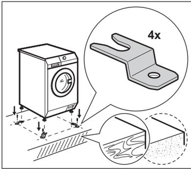
Si vous installez l'appareil sur un sol en béton, veillez à commander le kit de fixation adapté.
