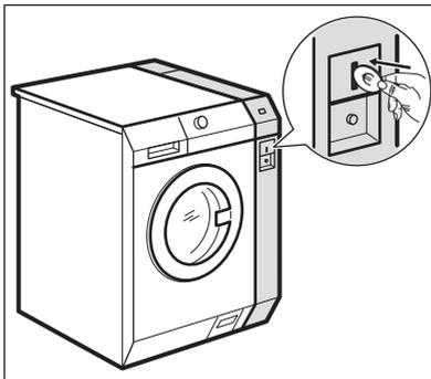
Si l'appareil se trouve dans un lieu public, il peut être raccordé à une machine à pièces.
