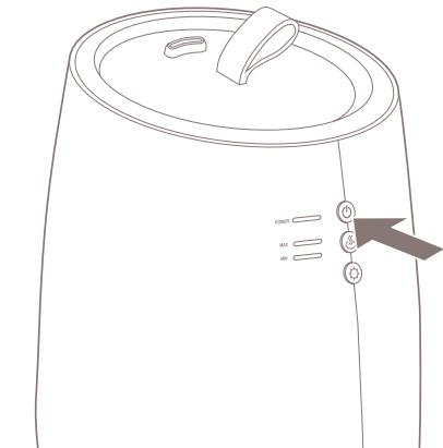
**Hinweis:** Wechselt die Strom-/Wasseranzeige bei Einschalten des Geräts von blau zu rot ist der Wasserstand im Gerät zu niedrig. Füllen Sie von oben Wasser in den dafür vorgesehenen Wassertank (siehe Punkt 2 „Befüllen des Wassertanks“).
