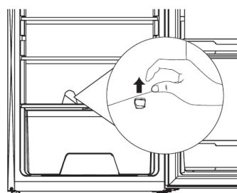
Remarque: Gardez le canal de condensation et l'orifice d'évacuation propres de sorte que la condensation puisse s'écouler.
