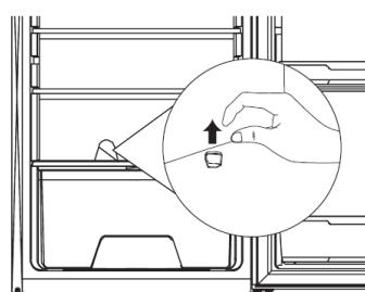
Die Rückwand taut sich automatisch ab. Die Kondensationsflüssigkeit läuft über den Kondensationskanal und wird zum Kühler geführt, wo sie verdampft.
