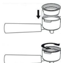
NOTA: Para extraer y limpiar el filtro, haga girar el filtro a izquierda y derecha para alinear la muesca del filtro con el surco del portafiltros.
