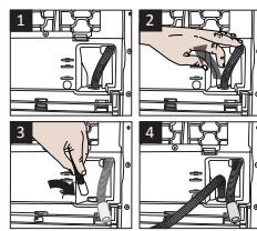
Trek de slang met de hand achter de droger om deze los te koppelen vanwaar hij is aangesloten. Gebruik geen gereedschappen om de slang te verwijderen.
