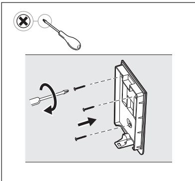
**4. Закрепите настенный держатель с помощью прилагаемых винтов и пластмассовых анкеров. Убедитесь, что он установлен прямо и надежно прикреплен к стене.**
