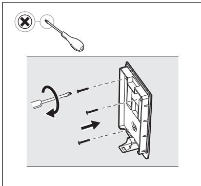
**4. Stenski nosilec pritrdite s priloženimi vijaki in plastičnimi sidri ter se prepričajte, da je raven in trdno pritrjen na steno.**
