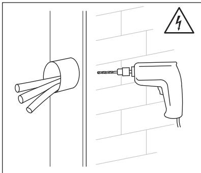
**3. Duvara delikleri açın ve bağlantı parçalarını yerleştirin.**
