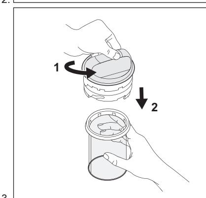
Filtreyi açmak için bkz. Resim 1 ve 2:
