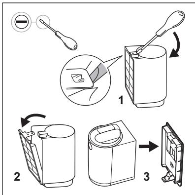
**1.** Извлеките фильтр из упаковочной коробки и снимите настенный держатель с помощью плоской отвертки.
