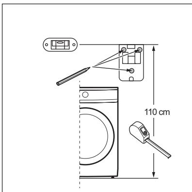
b. Bruk et vater for å kontrollere at de tre borepunktene står vannrett og på linje før boring.
