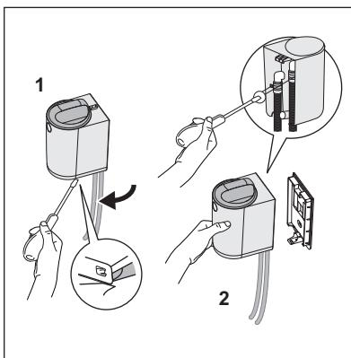
**8.** Se aparecer alguma água durante o primeiro ciclo, pare o programa imediatamente. Desligue a máquina de lavar e retire a ficha da tomada elétrica. Antes de prosseguir com o procedimento de desmontagem, verifique se a tampa do filtro se mantém na posição de bloqueio para evitar qualquer fuga de água enquanto aperta os colares.
