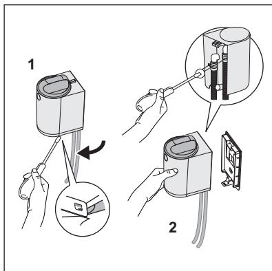
**8.** Hvis det dukker opp noe vann under den første syklusen, må du stoppe programmet umiddelbart. Slå vaskemaskinen AV og trekk støpselet ut av stikkontakten. Før du fortsetter med frakoblingsprosedyren, må du kontrollere at filterdekset holder seg i låst posisjon for å unngå vannlekkasje mens du strammer klemmene.
