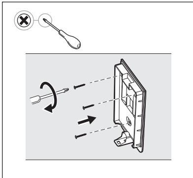
**4. Fastgør vægstøtten med de medfølgende skruer og plastikankre, og sørge for, at den er lige og sikkert fastgjort til væggen.**
