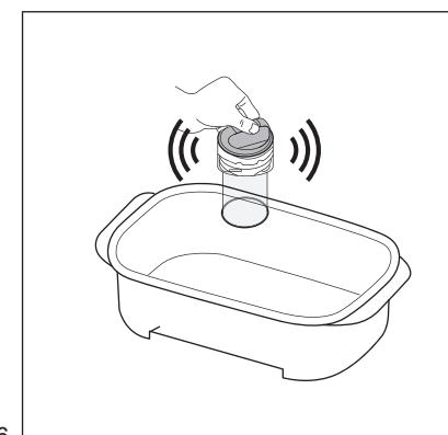
Wenn die Patrone vollständig verstopft ist, ist sie möglicherweise mit Schmutzwasser gefüllt.
