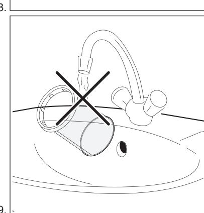
**Щоби зберегти позитивний вплив фільтра на довкілля, уникайте використання води для очищення фільтрувального картриджа. Натомість викидайте відходи, зібрані фільтрувальним картриджем, у звичайні сухі відходи (щоби уникнути розсіювання пластикового волокна у водному середовищі).**
