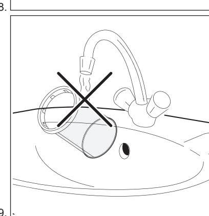
Om het milieu te beschermen moet het gebruik van water voor het reinigen van de filtercassette worden vermeden. Gooi in plaats daarvan het door de filtercassette opgevangen afval weg bij het algemene droge afval (voorkom verspreiding van plastic vezels in het water).
