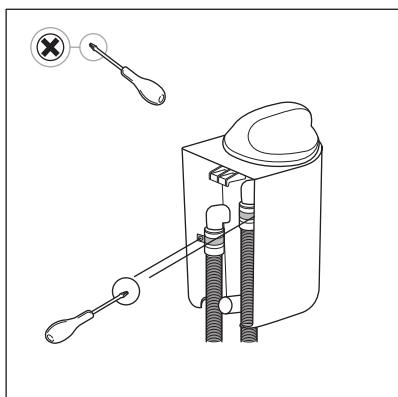
**i** Pri uporabi izvijača pazite, da ne poškodujete ohišja filtra ali cevi.
