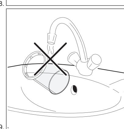
Per preservare l'impatto positivo del filtro sull'ambiente, evitare l'uso di acqua per pulire la cartuccia del filtro. Gettare invece i rifiuti raccolti dalla cartuccia del filtro nei rifiuti secchi generici (evitare la dispersione delle fibre in plastica nell'ambiente acquatico).
