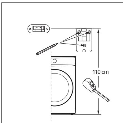
б. Перед свердлінням переконайтесь, що 3 відмітки для свердління розташовано рівномірно й на відповідній висоті, за допомогою покажчика рівня.
