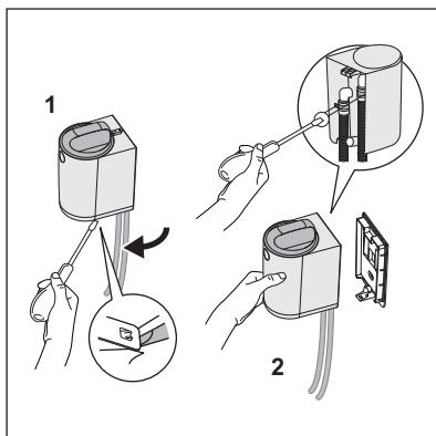
8. Si aparece agua durante el primer ciclo, para el programa inmediatamente. Apaga la lavadora (OFF) y desenchufala de la toma de corriente. Antes de proceder con el procedimiento de desacoplamiento, comprueba que la tapa del filtro permanece en la posición de bloqueo para evitar fugas de agua al apretar los cuellos.
