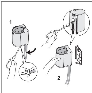
**8.** Če pride med prvim programom do iztekanja vode, takoj prekinite program. IZKLJUČITE pralni stroj in ga izklopite iz električne vtičnice. Preden nadaljujete s postopkom odstranjevanja, zagotovite, da je pokrov filtra v zaklenjenem položaju, s čimer med privijanjem objemk preprečite iztekanje vode.
