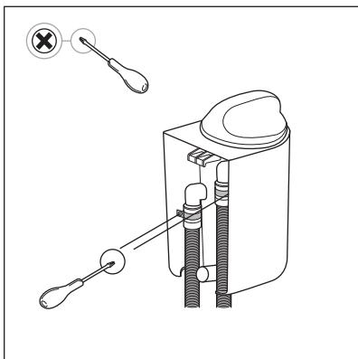
Vær forsiktig med skrutrekkeren så du ikke skader filterhuset eller slangene.
