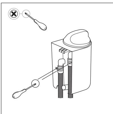
7. Під час приєднання корпусу фільтра до настінного тримача, після руху, показаного на малюнку, ви почуєте «клацання», що свідчить про правильне приєднання корпусу до настінного тримача.
