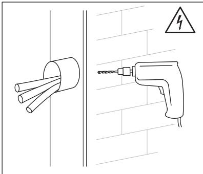
**3. Vyvrtejte do stěny otvory a vložte do nich hmoždinky.**
