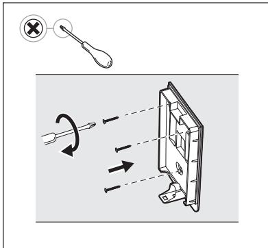
**4. Fixe o suporte de parede com os parafusos e buchas de plástico fornecidos, certificando-se de que está direito e bem fixo à parede.**
