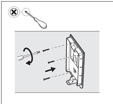
**4. Fissare il supporto a parete con le viti e i tasselli a espansione in plastica in dotazione, assicurandosi che sia diritto e fissato saldamente alla parete.**
