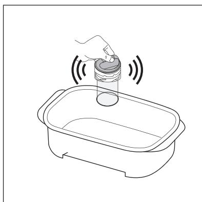
Si el cartucho está totalmente obstruido, puede estar lleno de agua sucia. Para preparar la limpieza se recomienda utilizar algún recipiente o pequeño utensilio de plástico; de esta forma podrías facilitar el proceso y evitar derrames sobre el entorno. Para eliminar el agua restante dentro del cartucho, vacíalo dentro de un recipiente o utensilio sosteniendo la tapa del conjunto y agitándola. El agua sale. Si queda algo de agua, continúa con el siguiente paso.
