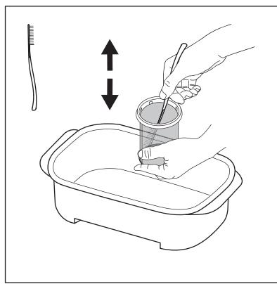
Afferrando la cartuccia all'interno del contenitore, utilizzare la spazzola-spatola in dotazione nella scatola del filtro. Con un movimento della spazzola verso l'alto e il basso, rimuovere quante più fibre possibili rimaste attaccate alla rete della cartuccia per facilitare la fuoriuscita dell'acqua.
