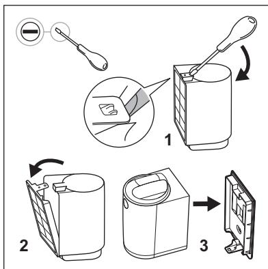
1. Retire o filtro da caixa de embalagem e retire o suporte de parede com a ajuda de uma chave de fendas.
