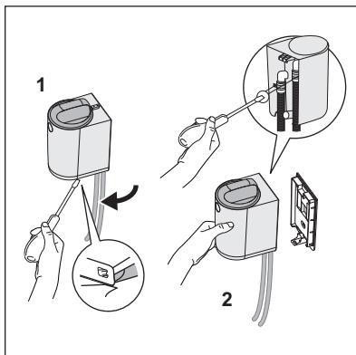
**8.** Dacă se surge apă în timpul primului ciclu, opriți imediat programul. OPRITI mașina de spălat și scoateți-o din priză. Înainte de a continua cu procedura de detașare, verificați dacă capacul filtrului rămâne în poziția blocată pentru a evita orice surgeri de apă în timp ce strângeți colierele. Detaşați întreg filtrul de pe suportul de perete:
