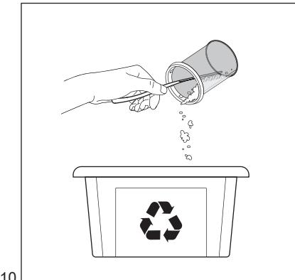
După ce apa a fost evacuate din cartuș, îndepărtați murdăria și micro fibrele din interiorul cartușului și aruncați-le în tomberonul dedicat deșeurilor uscate. Un prosop de hârtie poate fi folosit pentru a colecta cât mai mult material posibil.
