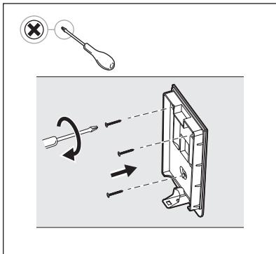
**4. Fäst väggstödet med de medföljande skruvarna och plastpluggarna och se till att det är rakt och säkert fäst vid väggen.**
