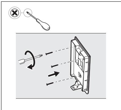
**4. Upevněte nástěnný držák pomocí dodaných či jiných vhodných šroubů a plastových hmoždinek a ujistěte se, že visí rovně a bezpečně přiléhá ke stěně.**
