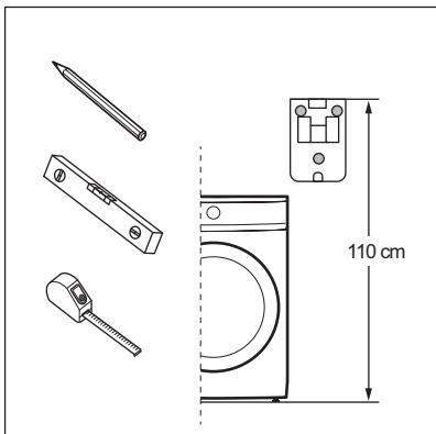
Sjekk hvor vanntømmingen finner sted før du plasserer veggstøtten. Filteret er utstyrt med ett avløpsrør med en lengde på 100 cm.
