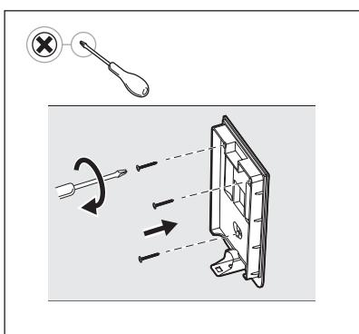
**4. Befestigen Sie die Wandhalterung mit den mitgelieferten Schrauben und Kunststoffdübeln und achten Sie darauf, dass sie gerade und sicher an der Wand befestigt ist.**
