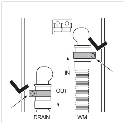
Introduceți colierele pe furtunuri și conectați țevile la corpul filtrului urmând indicațiile de **INTRARE/IEȘIRE** prezente pe partea din spate a corpului filtrului:
