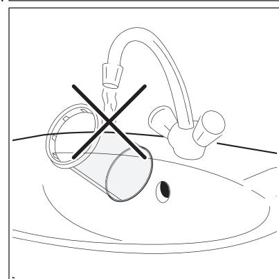
Чтобы использование фильтра не оказывало негативного воздействия на окружающую среду, выполните очистку фильтрующего картриджа без воды. Вместо этого отходы, собранные фильтрующим картриджем, можно утилизировать вместе с бытовыми сухими отходами (во избежание попадания пластиковых волокон в водную среду).
