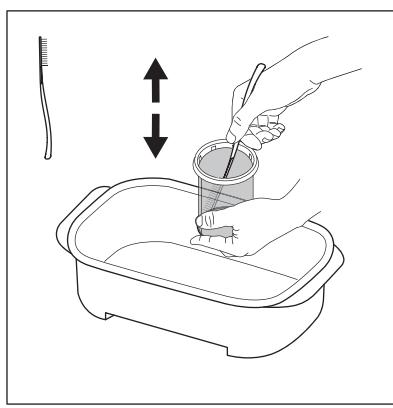
Утримуючи картридж усередині контейнера, скористуйтесь щіточкою-лопаткою, розташованою в коробці з фільтром. Рухаючи щітку вгору/вниз, максимально видаліть волокна, що застригли на сітці картриджа, щоби сприяти зливанню води.
