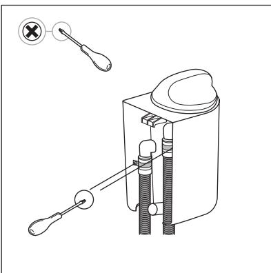
Let er bij gebruik van de schroevendraaier op dat u het filterhuis of de slangen niet beschadigt.
