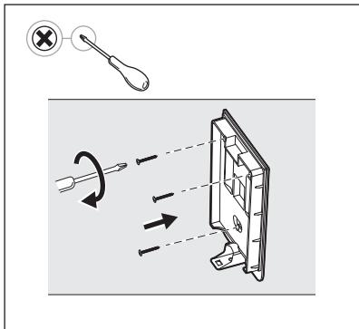
**4. Przymocuj wspornik ścienny za pomocą dostarczonych śrub i plastikowych kołków, upewniając się, że jest on prosto i pewnie zamocowany do ściany.**
