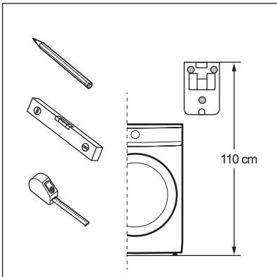
Przed ustawieniem wspornika ściennego należy sprawdzić, gdzie znajduje się punkt odpływu wody. Filtr wyposażony jest w jeden wąż odpływowy o długości 100 cm.
