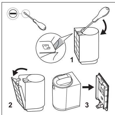
1. Filtr vyjměte z jeho obalu a pomocí plochého šroubováku z něj odpojte jeho nástěnný držák.
