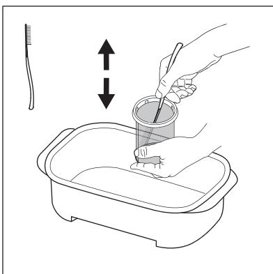
Halten Sie die Patrone in den Behälter und verwenden Sie das in der Filterbox enthaltene Pinsel-Spatel-Werkzeug. Durch Auf- und Abwärtsbewegungen der Bürste werden die am Patronennetz haftenden Fasern so weit wie möglich entfernt, um das Abfließen des Wassers zu erleichtern.
