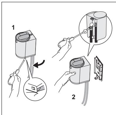
**8.** Om det kommer vatten under det första programmet, stoppa programmet omedelbart. Stäng AV tvättmaskinen och dra ut den ur eluttaget. Innan du fortsätter med lösgöringsproceduren ska du kontrollera att filterhöljet förblir i låst läge för att undvika vattenläckage när du drar åt kragarna. Ta bort hela filtret från vägghållaren:
