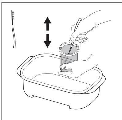
Κρατώντας τη φύσιγγα μέσα στο δοχείο, χρησιμοποιήστε το εργαλείο ψύκτρας-σπάτουλας που διατίθεται στο κουτί του φίλτρου. Με την κίνηση της βούρτσας πάνω/κάτω αφαιρέστε όσο το δυνατόν περισσότερο τις ίνες που είναι προσαρτημένες στο δίχτυ της φύσιγγας για να διευκολύνετε την εκκένωση του νερού.
