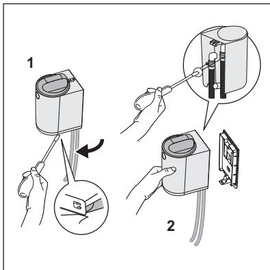
8. Если во время первого цикла стирки вы обнаружите утечку воды, немедленно остановите программу. Выключите стиральную машину и выньте вилку сетевого шнура из розетки. Прежде чем приступить к процедуре отсоединения, убедитесь, что крышка фильтра установлена в заблокированном положении во избежание утечки воды при затягивании хомутов.
