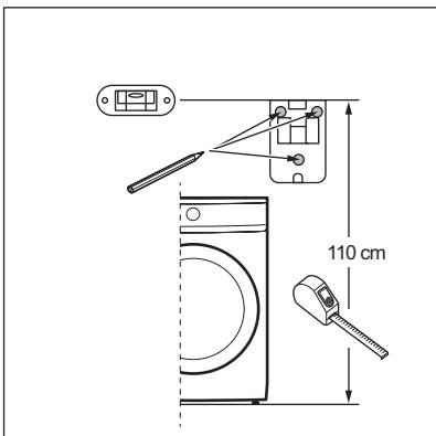
b. Prüfen Sie vor dem Bohren mit einer Wasserwaage, ob die 3 Bohrstempel waagerecht und gut ausgerichtet sind.
