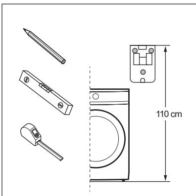
**i** Kontrollér, hvor dit dænpunkt er, før du placerer vægstøtten. Filteret er udstyret med et afløbsrør med en længde på 100 cm.
