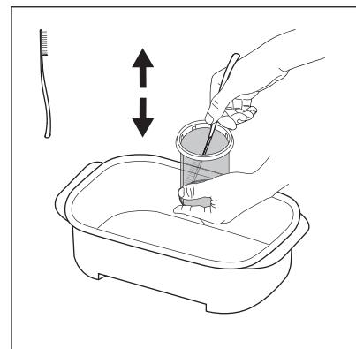
Удерживая картридж внутри контейнера, используйте для очистки щетку-лопатку, которая находится в корпусе фильтра. Двигая щетку вверх/вниз, удалите как можно больше волокон с сетки картриджа, чтобы вода могла протекать беспрепятственно.
