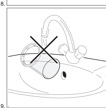
**Um die positiven Auswirkungen des Filters auf die Umwelt zu erhalten, vermeiden Sie die Verwendung von Wasser zur Reinigung der Filterpatrone. Werfen Sie stattdessen die von der Filterpatrone gesammelten Abfälle in den allgemeinen Hausmüll (vermeiden Sie die Dispersion von Kunststofffasern in der Wasserumgebung).**
