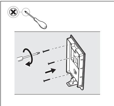
**4. Bevestig de wandsteun met de meegeleverde schroeven en plastic ankers en zorg ervoor dat deze recht en stevig aan de wand is bevestigd.**
