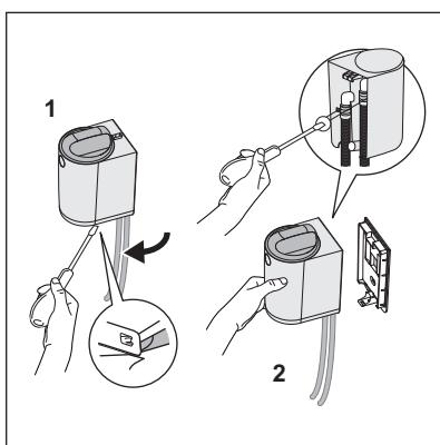
**8.** Якщо під час першого циклу витікатиме вода, негайно зупиніть програму. ВИМКНІТЬ пральну машину та витягніть вилку з електричної розетки. Перш ніж від'єднувати фільтр, переконайтесь, що кришка фільтра залишатиметься в заблокованому положенні, щоб уникнути витікання води під час затягування хомутів. Від'єднайте весь фільтр від настінного тримача:
