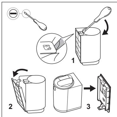
1. Vyberte filter z obalovej škatule a pomocou plochého skrutkovača vyberte držiak na stenu.
