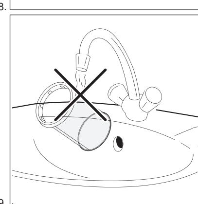
Pentru a conserva impactul pozitiv al filtrului asupra mediului, evitați utilizarea apei pentru curățarea cartușului filtrant. În schimb, aruncați reziduurile colectate de cartușul filtrant în tomberonul dedicat deșeurilor uscate (evitați dispersia fibrelor de plastic în mediul acvatic).
