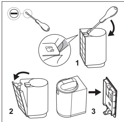
**1. Verwijder het filter uit de verpakking en verwijder de wandsteen met behulp van een platte schroevendraaier.**
