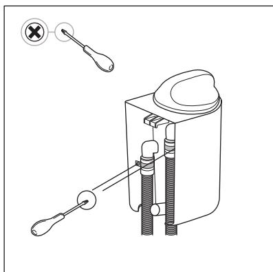
Var försiktig så att du inte skadar filterhuset eller slangarna när du använder skravmejseln.
