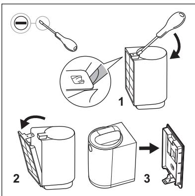
1. Filter odstranite iz embalaže in s pomočjo ploščatega izvijača odstranite stenski nosilec.
