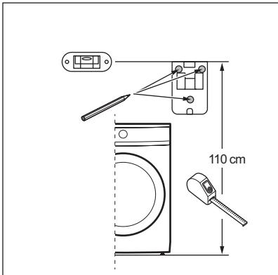
b. Χρησιμοποιήστε ένα επίπτεδο για να ελέγξετε ότι οι 3 διατρήσεις είναι οριζοντιωμένες και καλά ευθυγραμμισμένες πριν από τη διάτρηση.
