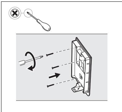
**4. Pripojte držiak na stenu dodanými skrutkami a plastovými hmoždinkami, pričom sa uistite, že je držiak rovný a bezpečne prichytený k stene.**
