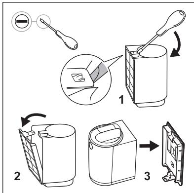
**1.** Αφαιρέστε το φίλτρο από το κουτί συσκευασίας και αφαιρέστε το στήριγμα τοίχου με τη βοήθεια ενός κατσαβιδιού με επίπεδη μύτη.
