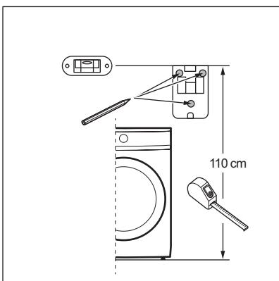
b. Brug et vaterpas til at kontrollere, at de 3 borestempler er i vater og korrekt justeret inden boring.
