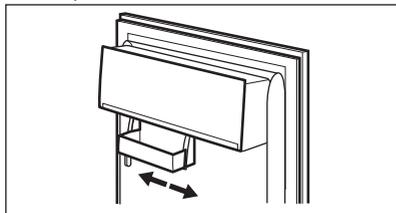
Ce modèle est équipé d'un compartiment de rangement variable qui peut être déplacé latéralement.
