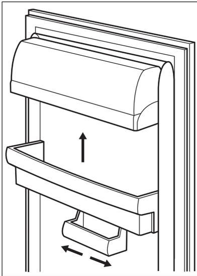
Dieses Modell ist mit einer variablen Lagerbox ausgestattet, die seitlich bewegt werden kann.
