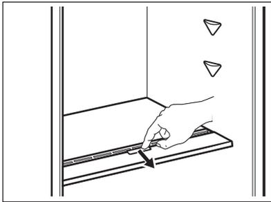
Um das Gerät zur Feuchtigkeitskontrolle zu entfernen, öffnen Sie die Schublade unter dem Glasregal und ziehen Sie die Abdeckung heraus.
