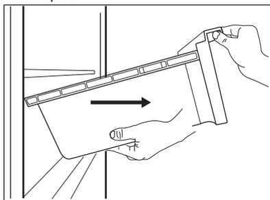
Om het glazen deksel van het GreenZone compartiment te verwijderen:
