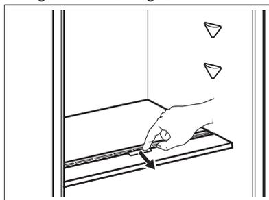
Om de vochtigheidsregelaar te verwijderen, opent u de lade onder het glazen schap en trekt u het deksel eruit.
