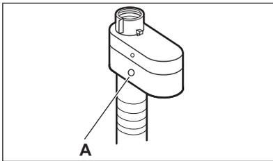
Si cela se produit, fermez le robinet d'eau et contactez le centre de service agréé pour obtenir des informations sur le remplacement du tuyau d'entrée.
