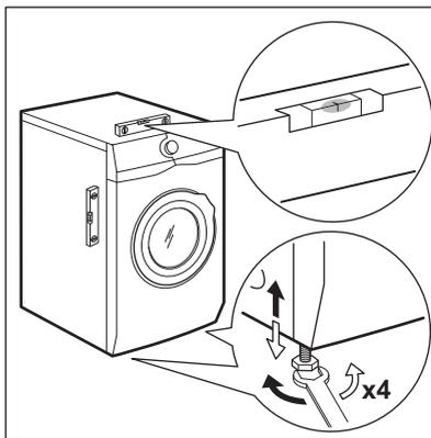
L'appareil doit être de niveau et stable.
