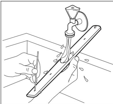
5. Setzen Sie zum Einsetzen des Sprüharms das Montageelement in
