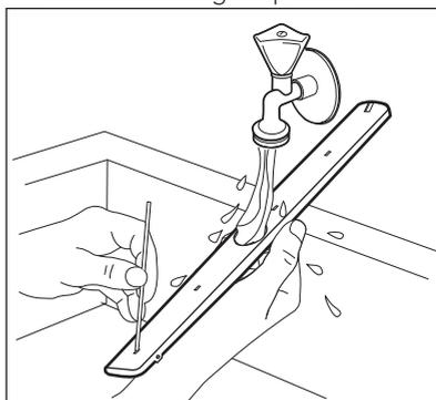
5. Steek om de sproeiarm terug te plaatsen het bevestigings-element in de sproeiarm en bevestig deze in de toevoerleiding door deze naar rechts te draaien. Zorg ervoor dat het bevestigings-element op zijn plek dicht klikt.
