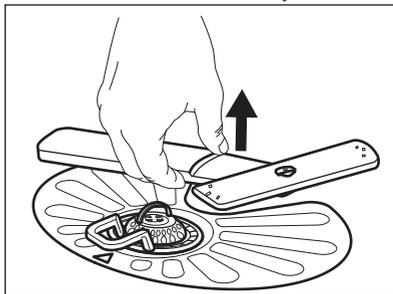
2. Reinig de sproeiarm onder stromend water. Gebruik een smal en puntig gereedschap, bijv. een tandenstoker, om de vuildeeltjes uit de gaten te verwijderen.
