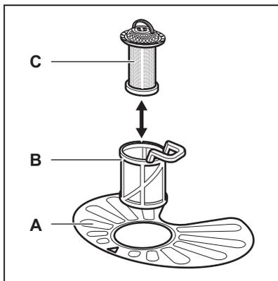
1. Draai de filter (B) linksom en verwijder het.
