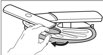
4. Reinigen Sie die Filter.
