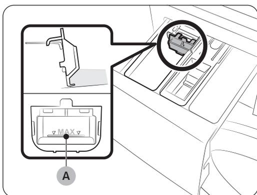
Insérez d'abord le guide à lessive liquide fourni dans le
