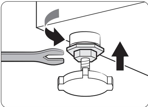
3. Une fois la mise à niveau effectuée, serrez les écrous à l'aide de la clé.
