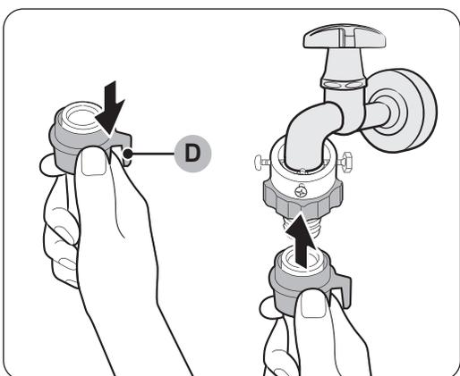
6. Tout en tirant vers le bas la **partie (D)** sur le tuyau d'eau, raccordez le tuyau d'eau à l'adaptateur. Ensuite, relâchez la **partie (D)**. Le tuyau s'enclenche dans l'adaptateur en émettant un son.
