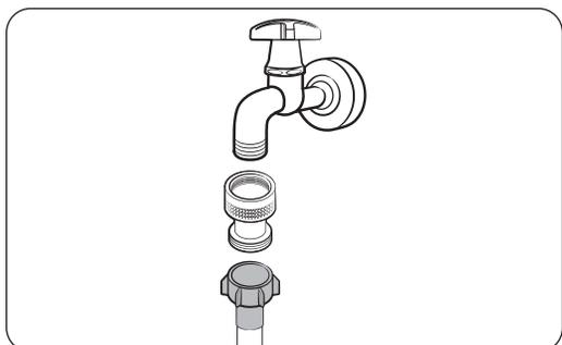
Avant de brancher le tuyau d'eau sur le robinet d'eau, branchez la vanne de vérification fournie sur le robinet d'eau, puis raccordez le tuyau d'eau.
