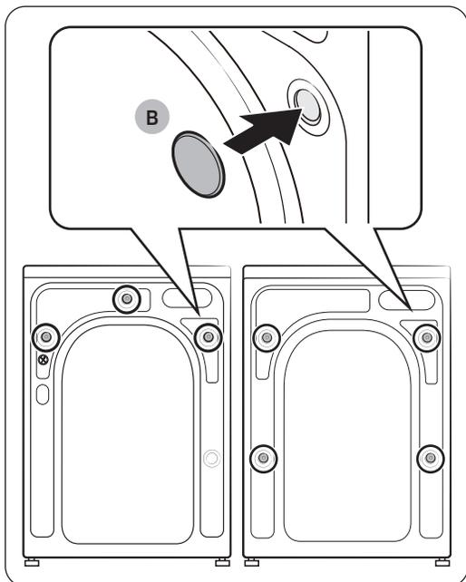
3. Insérez les **cache-boulons (B)** dans les orifices (entourés sur l'illustration).
