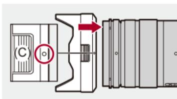
**2 Faites tourner le parasoleil dans le sens de la flèche pour aligner le repère (D) (○) présent sur celui-ci avec le repère situé à l'extrémité de l'objectif.**
