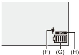
(F) Alimentation du câble de raccordement USB
