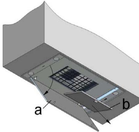
Der Filter in kochendem Wasser mit fettlösenden Reinigungsmitteln säubern. Nach der Reinigung der Filter abtropfen und trocknen lassen.
