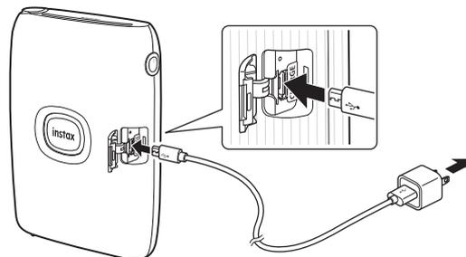
Connectez l'imprimante à l'aide du câble micro USB fourni à un adaptateur secteur USB (fourni avec votre smartphone), puis connectez l'adaptateur secteur USB à une alimentation électrique intérieure.
