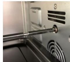
4. Zorg dat het vierkante uiteinde van het draaispit rust op de draaispitsteun aan de linkerkant van de ovenwand.
