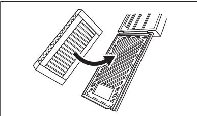
2. Druk het filter voorzichtig omlaag terwijl u de plastic behuizing sluit en een klik hoorbaar is.
