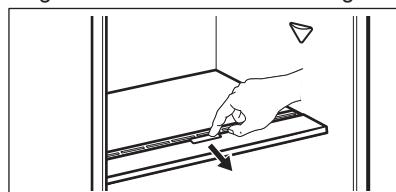
Om de vochtigheidsregelaar te verwijderen, opent u de lade onder het glazen schap en trekt u de afdekking eruit.
