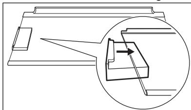
4. Setzen Sie die Glasablage wieder in den Kühlraum ein. Beschädigen Sie den Filter nicht.
