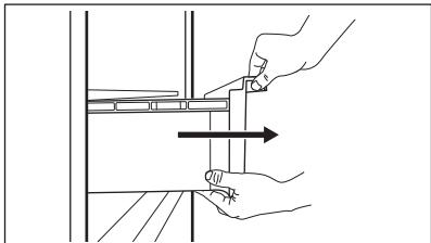
3. Heben Sie die Vorderseite der Schublade an.
