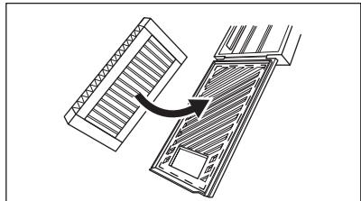
2. Halten Sie den Filter gedrückt, während Sie das Kunststoffgehäuse schließen, bis Sie ein Klicken hören.
