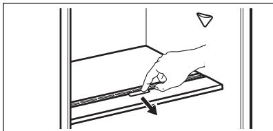
Um das Gerät zur Feuchtigkeitskontrolle zu entfernen, öffnen Sie die Schublade unter dem Glasregal und ziehen Sie die Abdeckung heraus.
