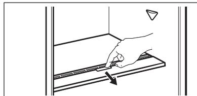
Pour retirer le dispositif de contrôle de l'humidité, ouvrez le bac sous l'étagère en verre et retirez le couvercle.
