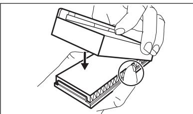
3. Verwijder het bovenste glazen plateau uit het vriesvak. Schuif de kunststof behuizing met het luchtfILTER aan de linkerkant van het glazen plateau.
