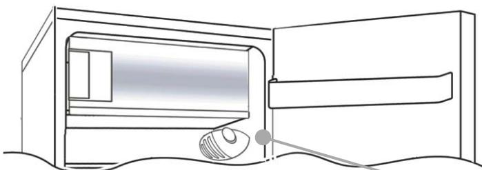
Le thermostat commandant l'appareil se trouve en haut à droite à l'intérieur du réfrigérateur. Pour vérifier que l'appareil fonctionne, assurez-vous que le bouton du thermostat ne se trouve pas en position "0".
