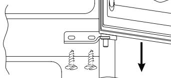
Verwijder de dopjes (A) en (B), draai de schroeven los en verwijder het paneel.
