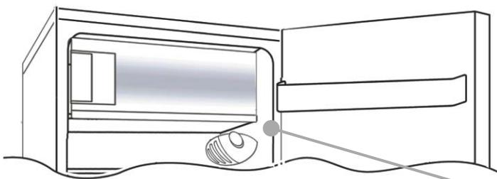
De thermostaatregelaar van het apparaat bevindt zich rechtsboven in het koelkastgedeelte. Om te controleren of het apparaat functioneert dient u erop te letten dat de knop van de thermostaat niet op „0“ staat.
