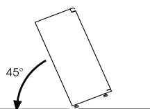
Verwijder het onderste scharnier door de schroeven, dopje en volgring te verwijderen, en verwijder vervolgens de onderste deur
