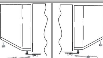
Retirez les caches (A) et (B), desserrez les vis et enlevez partiellement le bandeau.
