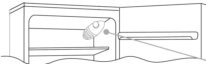
La scatola termostato per il controllo dell'apparecchio è collocata all'interno della cella frigo in alto a destra. Per essere certi che l'apparecchio stia funzionando accertarsi che la manopola termostato non sia sulla posizione **•**.
