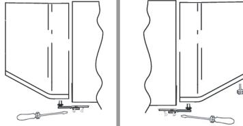
Avlägsna täckpluggarna (A) och (B), skruva loss skruvarna och avlägsna delvis panelen
