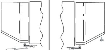
Снимите два расположенных сверху колпачка, которыми зарыты винты, и выверните два винта
