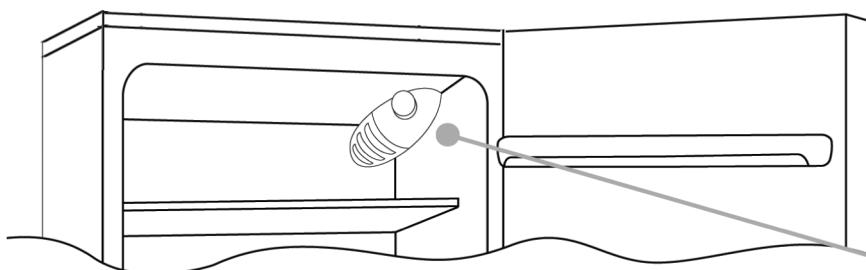
Termostat určený k ovládání spotřebiče je umístěný uvnitř chladničky vpravo nahore. Pokud chcete zkontrolovat, že zařízení opravdu funguje, přesvědčete se, že termostat není nastavený v poloze „0“.
