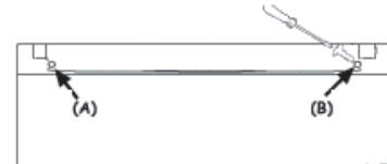
Выверните два винта, расположенные на задней стенке холодильника, и снимите верхнюю крышку холодильника
