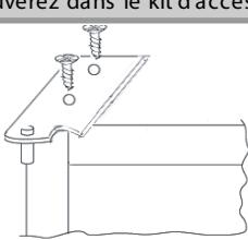
Retirez le cache du côté gauche et insérez-le dans les inserts du milieu et du bas sur le côté droit.
