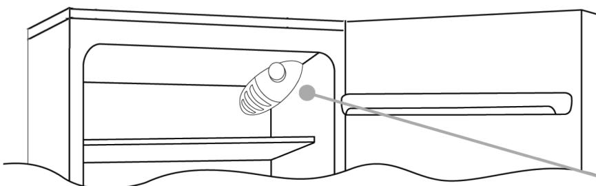
Laitteen säätoön tarkoitettu termostaattilaatikko sijaitsee jäääkaappiosaston sisällä oikealla ylhäällä. Kun haluat tarkastaa, että laite toimii, varmista, että termostaatinuppi ei ole asennossa "0".
