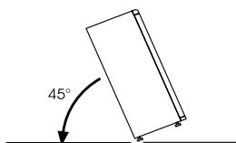
Verwijder het onderste scharnier door de schroeven, dopje en volgring te verwijderen, en verwijder vervolgens de onderste deur
