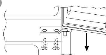
Draai de twee schroeven aan de achterzijde van de deur los en verwijder de bovenzijde.
