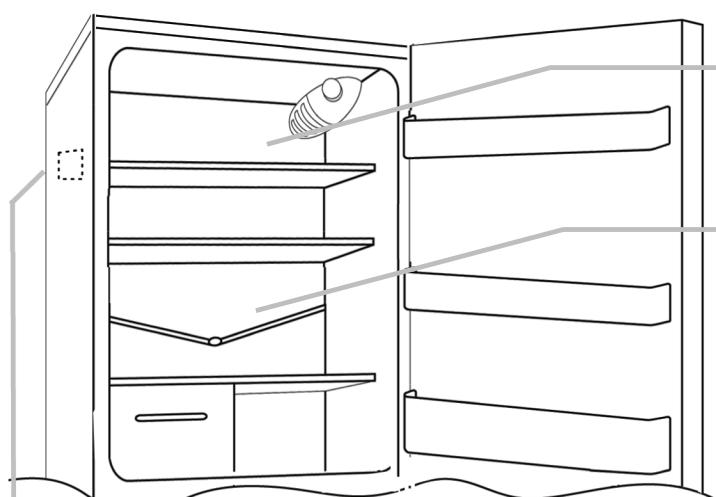
Het koelkastcompartment van dit apparaat wordt automatisch ontdooid.
