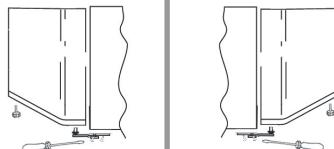
Entfernen Sie die Schutzkappen (A) und (B), lösen Sie die Schrauben und ziehen Sie die Stirnwand teilweise her aus.
