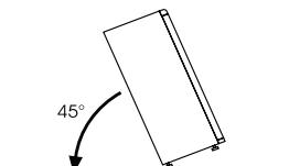
Снимите нижнюю петлю двери. Для этого выверните винты, и снимите колпачок и шайбы, а затем снимите дверь холодильника.
