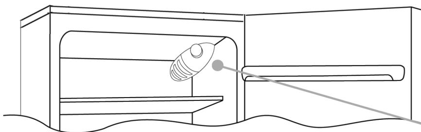
A caixa do termóstato que controla o equipamento está localizada dentro do compartimento do frigorífico no lado superior direito. Para verificar se o equipamento está a funcionar, certifique-se de que o botão do termóstato não está regulado para „0“.
