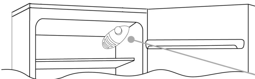
La caja del termostato que controla la aplicación se encuentra ubicada dentro del compartimento del frigorífico en la zona superior derecha. Para comprobar si la aplicación está funcionando, asegúrese de que la rueda del termostato no esté puesta en "0".
