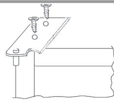
Rimuovere il tappo sulla parte sinistra e inserirlo sulla parte destra delle testatine centrali e inferiore.
