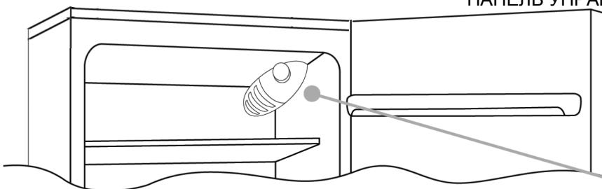
Термостат, с помощью которого задается нужная температура в холодильнике, расположен внутри холодильной камеры (в правом верхнем углу). Чтобы проверить, что холодильник работает, убедитесь в том, что ручка термостата не установлен в положение "0".
