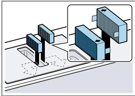
5. Insérez les autres filtres anti-odeurs ou filtres acoustiques à gauche et à droite de l'appareil.
