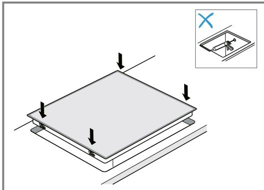
3. En présence de plans de travail carrelés, étanchéifier les joints du carrelage avec un joint en silicone.
